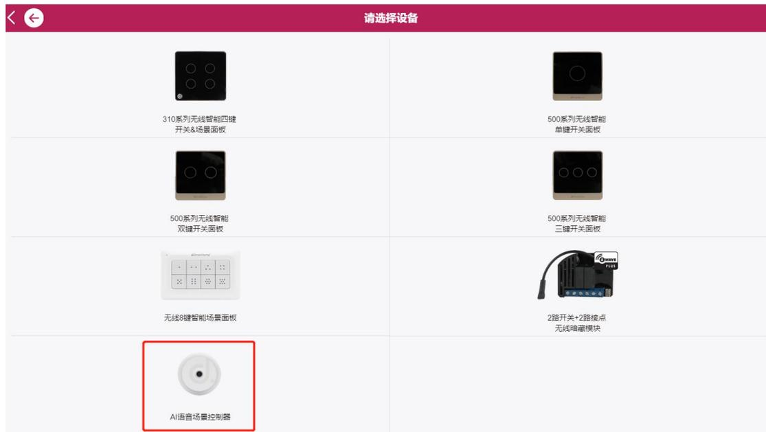
3、d1 主机进入添加设备模式，在倒计时内进行模块认证的操作。由于 d1 主机在添加 Z-wave 设备的时候会降低 Z-wave 无线信号功率（避免出现将邻居房间的 Z-wave 设备错误认证到主机内的情况），所以需要将无线智能插座拿至距离 d1 主机 3 米以内的位置进行添加，添加结束后在将面板安装到原位置
