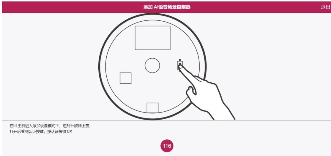
(1) 在 d1 主机进入添加设备模式下，按设备的认证/删除按键 1 次（逆时针轻轻旋转图 1 上的扣盖打开，图 2 方框标注的 S1 按键即为认证/删除按键）
