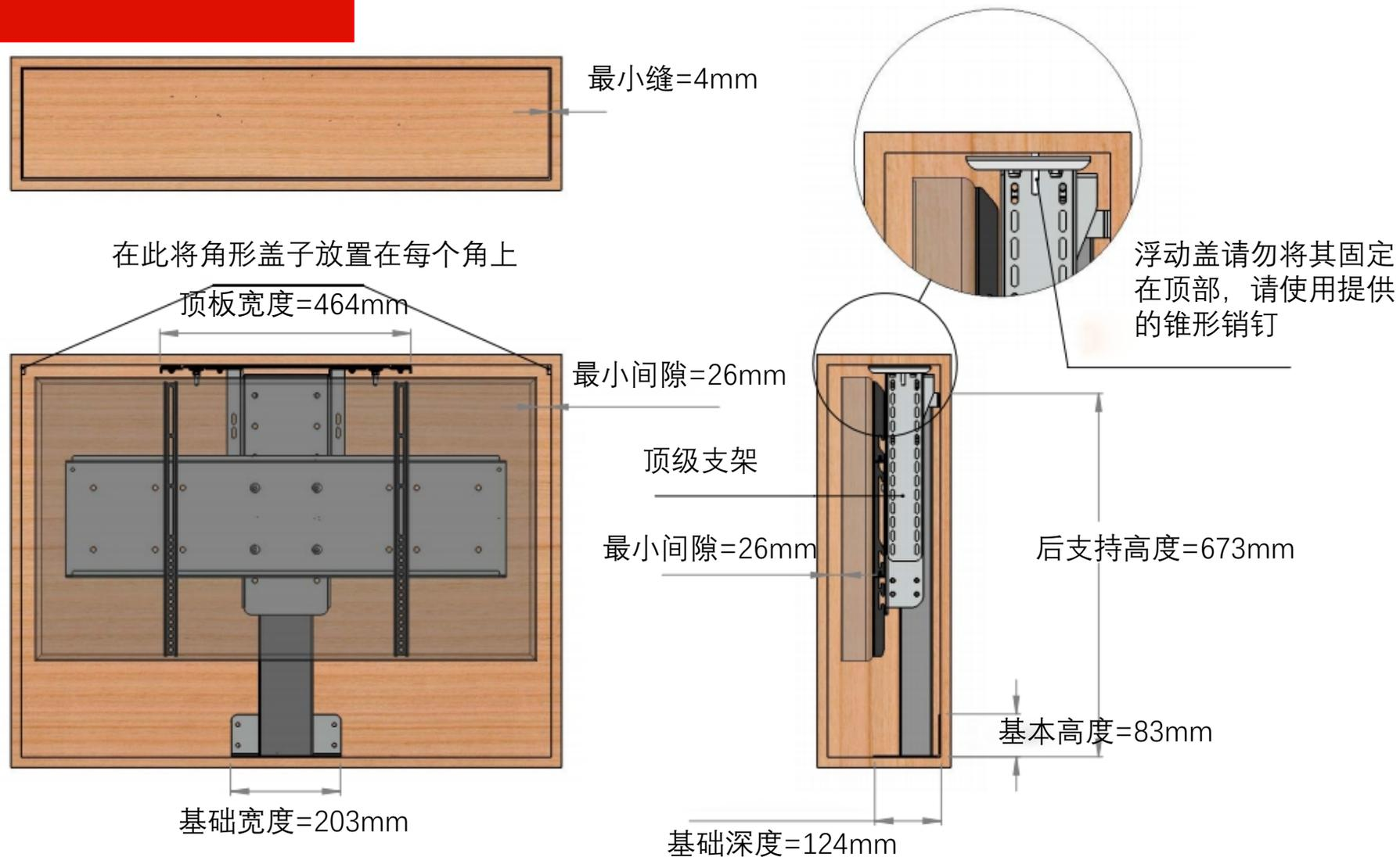
注意：1.顶部支撑支架允许顶板在不带盖子的情况下被冲刷。2.锥形销允许使用带盖的护盖浮动。3.盖子上有45度的锥角，可以将最小缝隙减小到2mm。
