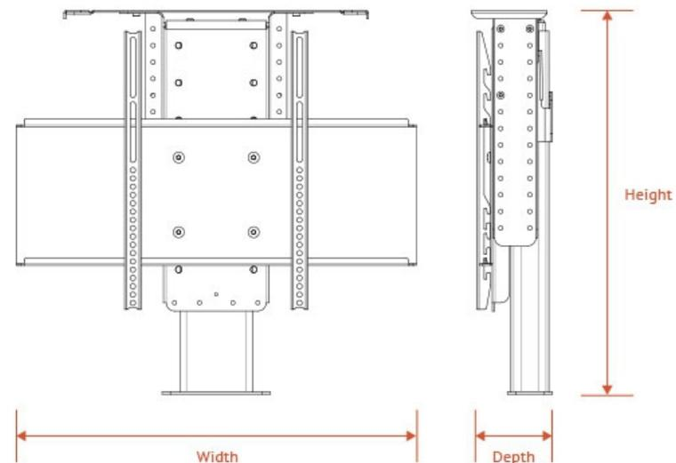
高度：最小23英寸/最大31英寸
