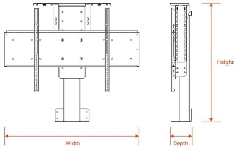
高度：最小28.5英寸/最大40.5英寸/以1/4英寸的增量可调
